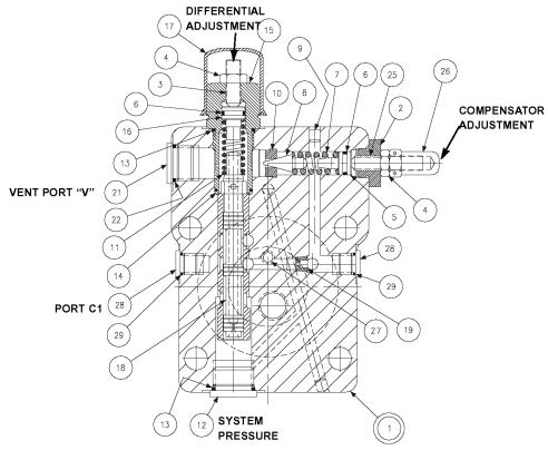
FIGURE 10 TORQUE LIMITER CAP
