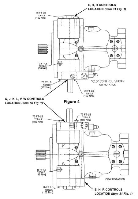
Figure 5 CONTROL ORIENTATION VERSUS PUMP ROTATION
